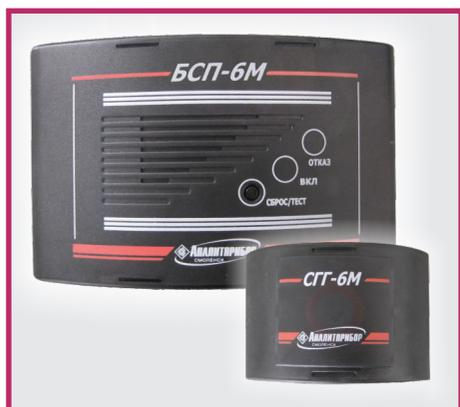
**Предназначен** для непрерывного автоматического контроля содержания топливных газов (природного по ГОСТ 5542-87 и газов углеводородных сжиженных по ГОСТ 20448-90) в воздухе промышленных и коммунально-бытовых помещений и выдачи сигнализации о превышении установленных значений объемной доли горючих газов.
