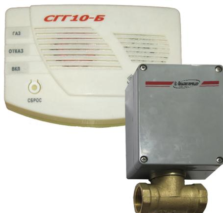
**Предназначены** для использования в системах дистанционного аварийного отключения потребителей в качестве запорного органа в трубопроводных системах для управления потоком топливных углеводородных газов (природного и сжиженного) с рабочим давлением до 0,005 МПа, в комплекте с СГГ10-Б. Клапан изготавливается для трубопроводов с условным проходом DN15, DN20, DN25, DN32.
