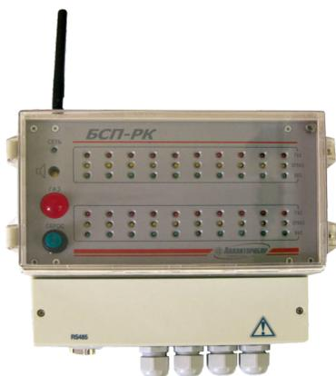
**Предназначен** для приема по радиоканалу информации от сигнализатора горючих газов СГГ10-Б-РК, передачи этой информации по каналу GSM и выдачи дублирующей световой и звуковой сигнализации, соответствующей состоянию сигнализаторов.
