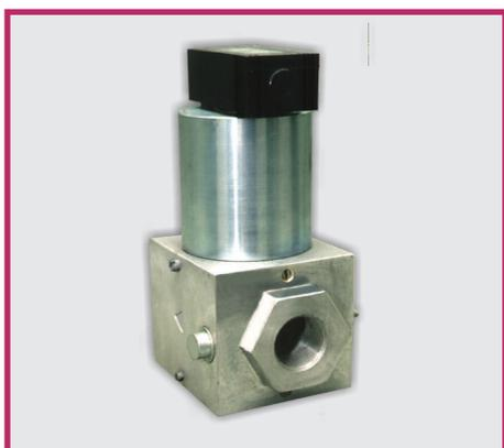
**Предназначены** для использования в системах дистанционного управления газогорелочных устройств паровых и водогрейных котлов, теплогенераторов, бытовых отопительных установок и в технологических трубопроводных системах для управления потоком газа в качестве запорно-регулирующего органа и органа безопасности.
