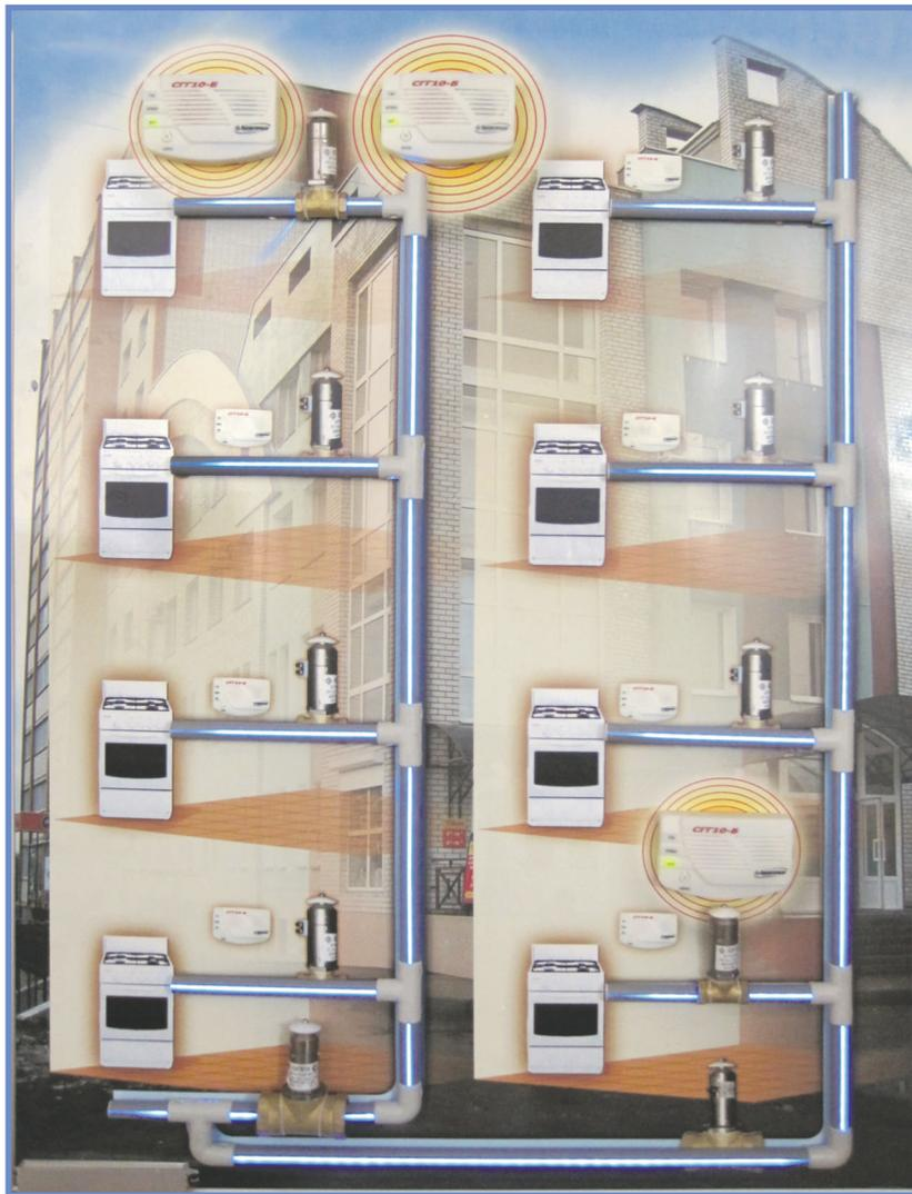
**Сигнализатор СГГ10Б. Монтажная схема**
